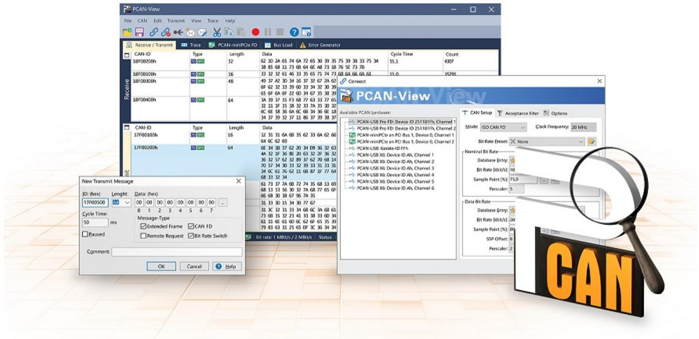
CAN モニターPCAN-View は、CAN および CAN FD メッセージを表示、送信、および記録するための Windows ソフトウェアです。このソフトウェアは、Windows でのデバイス・ドライバー・パッケージのインストールとともにインストールされます。
