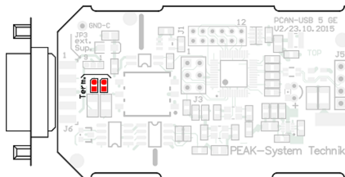
S / N 200000 からの PCAN-USB opto-decoupled (IPEH-002022)、CAN バス終端用のはんだフィールド
