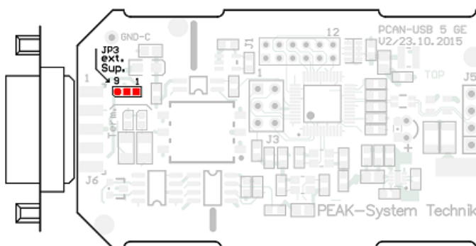
S / N 200000 からの PCAN-USB opto-decoupled (IPEH-002022)、ソルジャーフィールド R3
