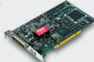
3 EDICpci: 据え置き使用向けPCIインターフェイスを備えた高性能車両通信インターフェイス。
