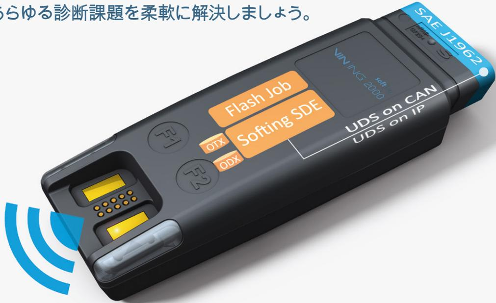
VIN|ING 2000 は現在の Wi-Fi または USB を用いたコンピューター接続の標準的使用事例を解決できるだけでなく、今後到来するリモート診断の課題やスタンドアロン運用にも完璧に対応しています。これを可能にしているのがデバイスに組み込まれている新型 Softing SDE です。これは実績のある標準的なコミュニケーションコンポー
