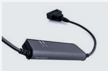
▲ Leaf Light HS v2: シングルチャンネルCANインターフェイス、Leaf Pro HS v2: 1チャンネルCAN/FDインターフェイス
