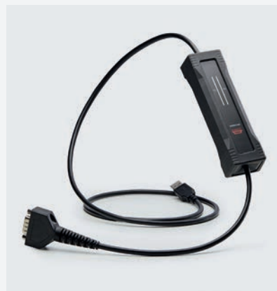
▲ U100: USB接続の堅牢な設計のシングルチャンネルCAN/FDインターフェイス。
