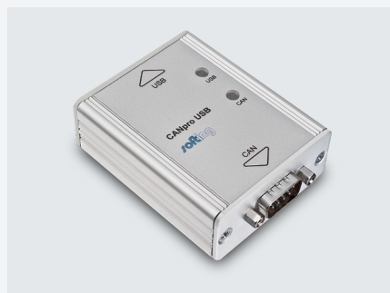
▲ CANpro USB: 堅牢なアルミニウム製ハウジングとUSB接続を備えたシングルチャンネルCANインターフェイス
